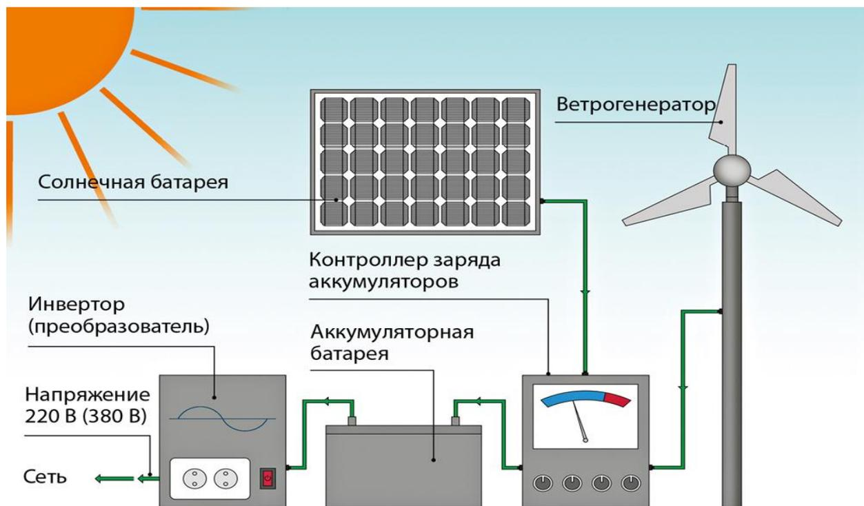
Бытовые ветрогенераторы – ветряки небольшой мощности, достаточной для обеспечения энергией частного дома. Для их работы нужна постоянная скорость ветра от 4 м/сек, а последние разработки оборудования позволяют вырабатывать электроэнергию и на слабых ветрах.
